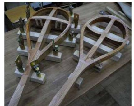
図4 収縮を妨げない開放型成形治具
