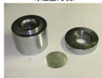
ダイスと板押さえ、試験片
