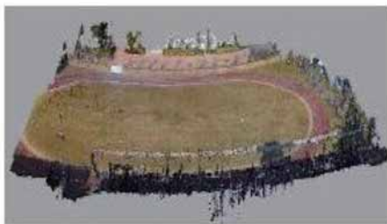
セルフキャリブレーション(標定点なし)
