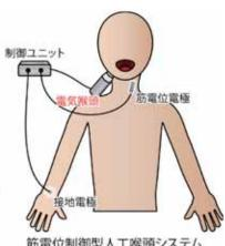
筋電位制御型人工喉頭システム
