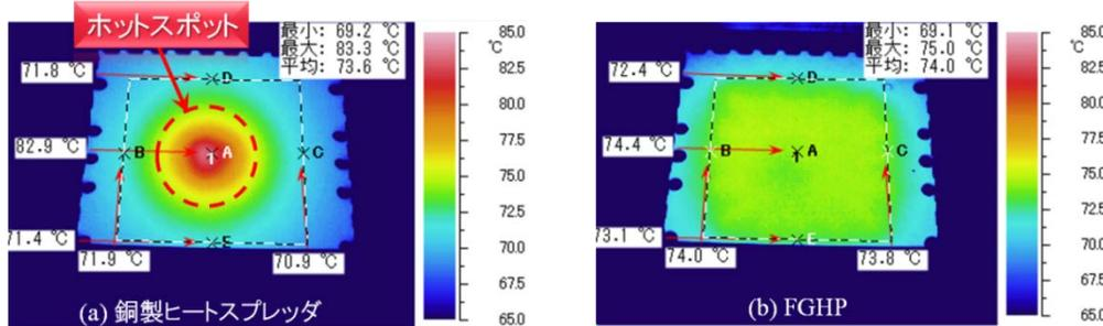
熱拡散性能に優れ、発生した熱を速やかに拡散させ、ホットスポットを発生させないことによって、**熱源の温度上昇を抑制！**
