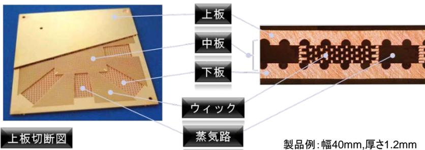
内部のウィック・蒸気路を高精細エッチング技術を駆使して形成することにより、内部構造の精密な制御が可能！
