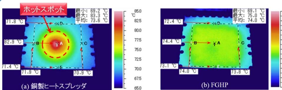
熱拡散性能に優れ、発生した熱を速やかに拡散させ、ホットスポットを発生させないことによって、**熱源の温度上昇を抑制！**
