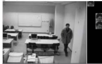
複数の天井カメラ映像処理により得た人物固有特徴に基づき統計的認識することで、完全非拘束状態で個人認証を行う。
